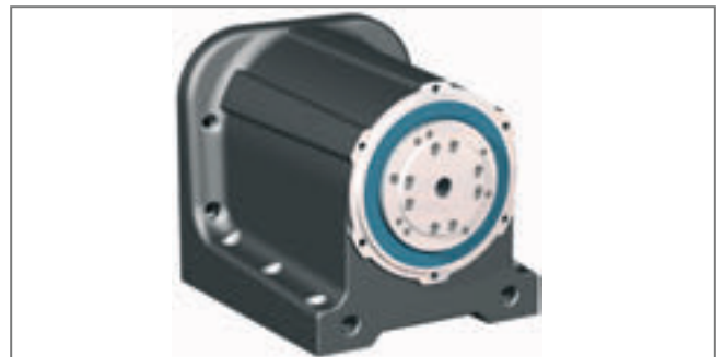
Rundmatningsbord / vridaxel RDH-S med precisionsdrift. Utväxling 1:51 eller 1:101, steg- eller servomotor, skyddsklass IP 65.
