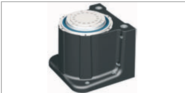
Rundmatningsbord / vridaxel RDH-M med precisionsdrift. Utväxling 1:51 eller 1:101, steg- eller servomotor, skyddsklass IP 65.
