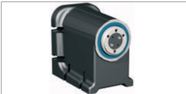
Rundmatningsbord / vridaxel RDH-XS med precisionsdrift. Utväxling 1:51 eller 1:101, steg- eller servomotor, skyddsklass IP 65.
